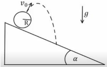
כדור ברדיוס  $R = 20\text{ cm}$  העשוי מחומר אחיד ואלסטי נזרק במהירות  $v_0 = 20 \frac{\text{m}}{\text{s}}$  בניצב למישור חלק (ללא חיכוך), המשופע בזווית  $\alpha = 30^\circ$  לאופק.
