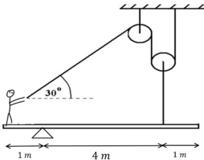
אדם שמסתו 65kg עומד בקצה קורה שמסתה 40kg. הקורה מונחת על ציר הנמצא במרחק 1m מהאדם. האורך הכולל של הקורה הוא 6m. האדם מחזיק בחוט העובר דרך שתי גלגלות כפי שמתואר באיור. הגלגלת השמאלית מחוברת לתקרה, הגלגלת הימנית לקורה במרחק 1m מהקצה השני.
