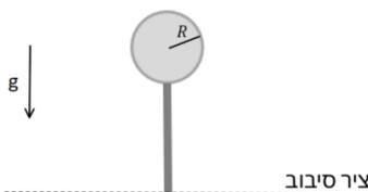
גוף קשיח מורכב ממוט בעל אורך  $L$  ומסה  $M$  המחובר בקצה אחד לדיסקה מלאה בעלת מסה  $m$  המפולגת באופן אחיד ורדיוס  $R$ . בקצה השני, המוט מחובר לציר אופקי.
