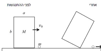
תיבה דו מימדית בגודל  $a \times b$  ומסה  $M$  נעה על משטח אופקי חלק במהירות  $v_0$ . ברגע מסוים התיבה מתנגשת אלסטית באבן עם מסה  $m$  הנמצאת במנוחה על המשטח. כתוצאה מההתנגשות התיבה ממשיכה בתנועה ימינה אך גם מתחילה להסתובב.
