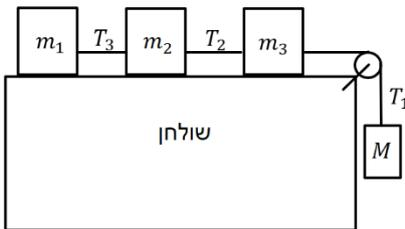
שלוש מסות:  $2m_1 = m_2 = m_3 = 15\text{ kg}$  נמצאות על שולחן אופקי ומחוברות בחוט דק למסה  $M = 20\text{ kg}$ . החוט עובר דרך גלגלת אחידה בעלת רדיוס  $R = 15\text{ cm}$  ומומנט התמד  $I = 0.7\text{ kg} \cdot \text{m}^2$  כמתואר באיור.
