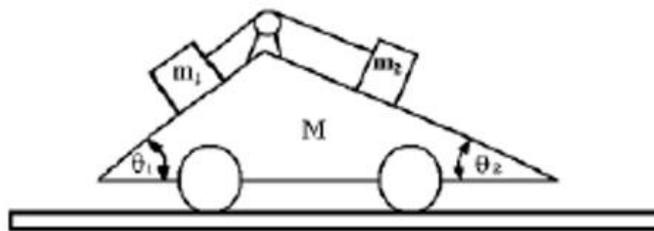
נתונים:  $M = 35\text{kg}$ ,  $m_1 = 10\text{kg}$ ,  $m_2 = 5\text{kg}$ ,  $\theta_1 = 45^\circ$ ,  $\theta_2 = 30^\circ$ .
